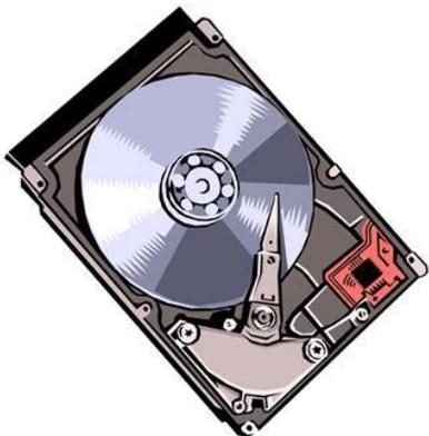
Жёсткий диск, как правило, встроен внутрь системного блока и постоянно находится там. Жёсткий диск служит для длительного хранения информации; на нём записаны все программы, управляющие работой компьютера.
