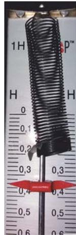
1) По рисунку 1 определите показания динамометра. Запишите результат с указанием погрешности, приняв её равной цене деления прибора.
