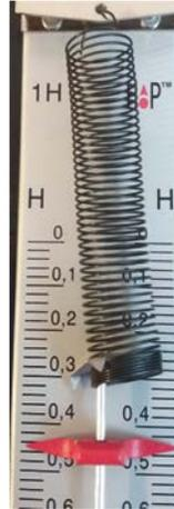
1) По рисунку 1 определите показания динамометра. Запишите результат с указанием погрешности, приняв её равной цене деления прибора.
